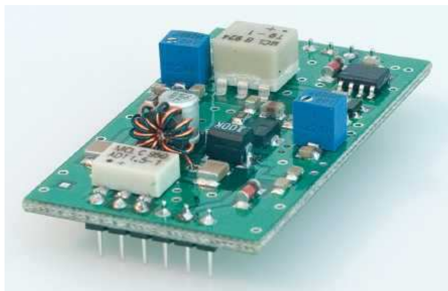
Fot. 3.18. Płytki wzmacniacza mocy. Może on być wykorzystany także w innych dowolnych własnych konstrukcjach. Dla zapewnienia dobrej liniowości prąd spoczynkowy tranzystorów powinien wynosić ok. 45 – 50 mA. Pobór prądu w trakcie nadawania z pełną mocą wynosi ok. 280 mA.
