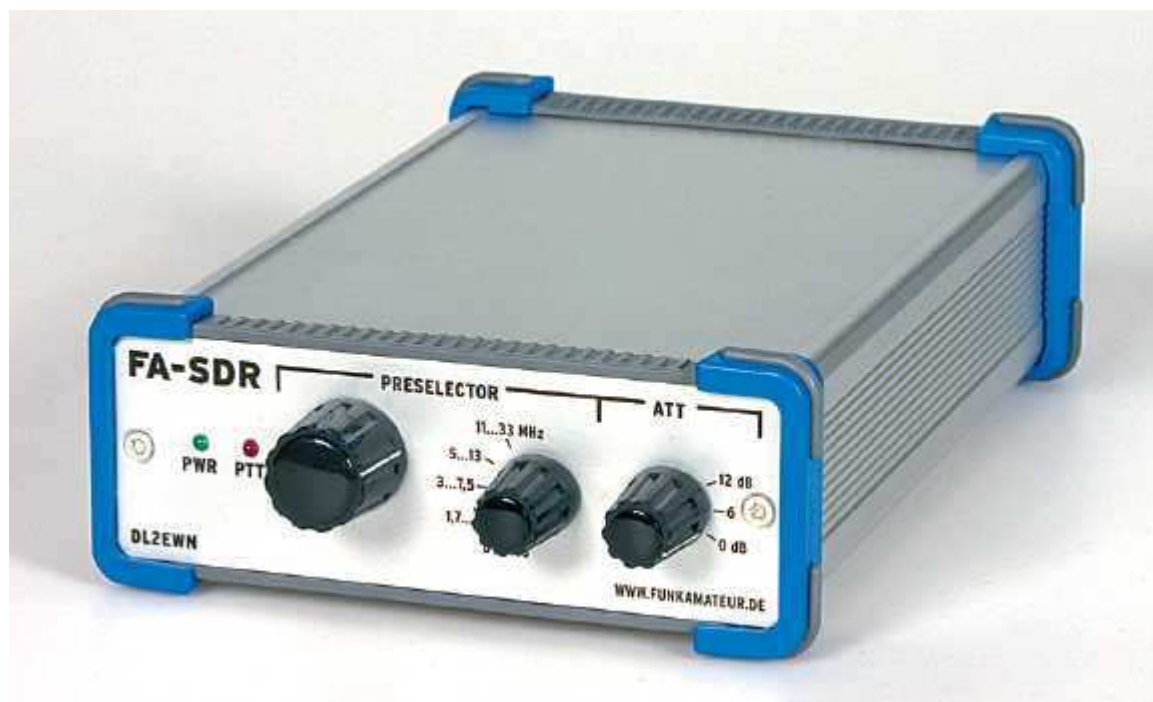
Fot. 3.17. Widok radiostacji FA-SDR w obudowie. Na przedniej ścianie znajdują się przełączniki tłumika i zakresów preselektora oraz gałka strojeniowa preselektora i diody świecące sygnalizujące włączenie zasilania i nadawanie.
